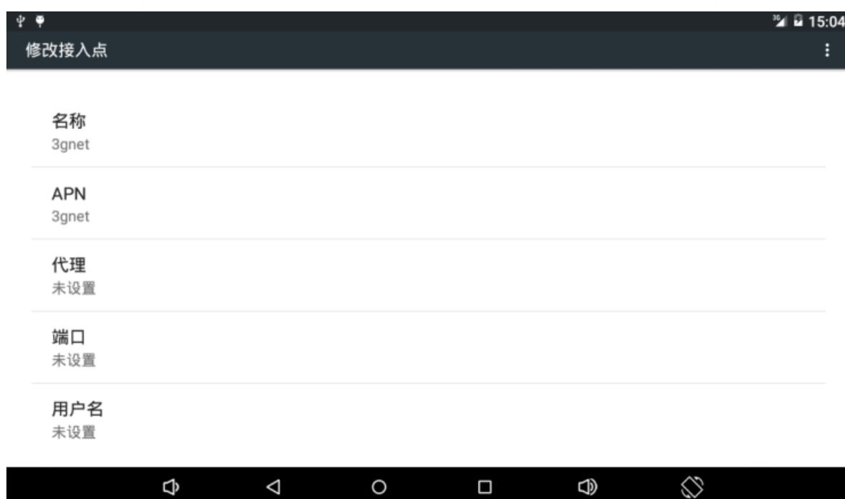
以联通卡为例，名称填写 3gnet，apn 填写 3gnet。点击右上角的按钮并保存。
