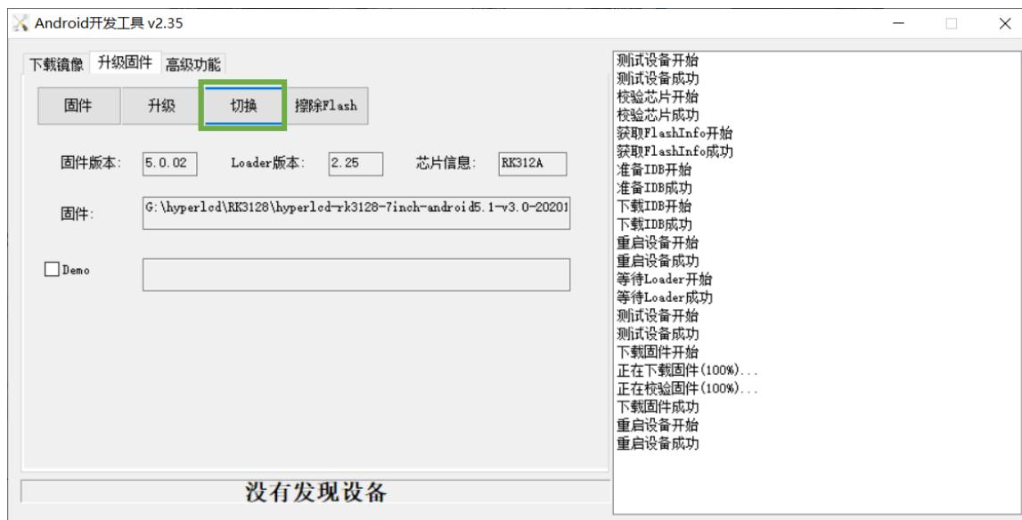
将安卓模组连上电脑，点击切换后模组会自动进入系统烧录模式，无需短接 ADK.
