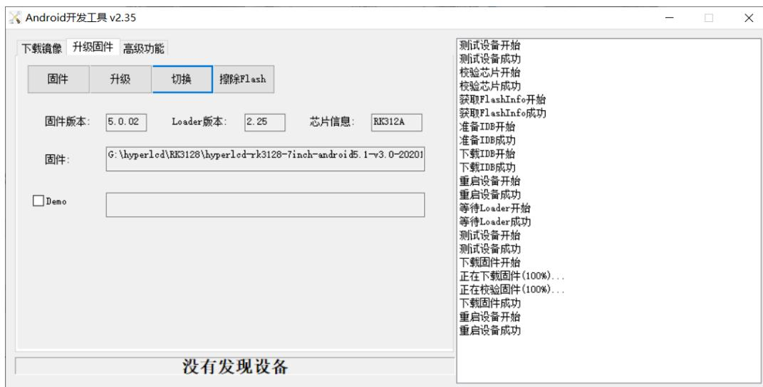
右侧提示下载固件成功，重启设备成功。至此，您的设备 img 系统文件更新成功。
