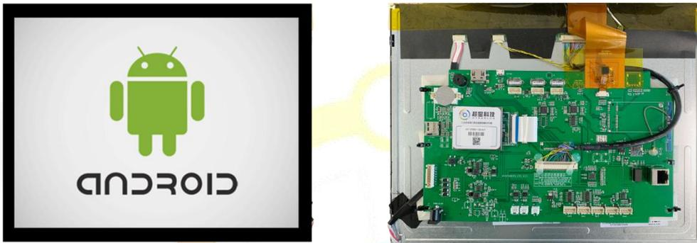
HY10768C150\_STD\_V3.0, 是一款基于 Rockchip RK3128 ARM 处理器的工业级安卓串口液晶屏。该产品集成了 Rockchip RK3128 的优良特性, 搭载四核 Cortex-A7 方案, 支持 1080p@60fps 下的大多数主流解码方案, 1080p@30fps 下的 H.265/H.264/MVC/VP8 解码方案。同时, 良好的 JPEG 图片处理性能和 3D GPU 让该平台兼容支持 OpenGL ES 2.0, OpenVG1.1.
