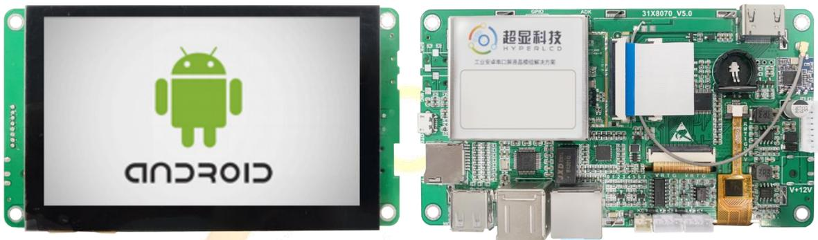
HY80480H050\_STD\_V5.0, 是一款基于 Rockchip RK3188 ARM 处理器的工业级安卓串口液晶屏。该产品集成了 Rockchip RK3188 的优良特性, 搭载四核 Cortex-A9 方案, 支持 1080p@60fps 下的大多数主流解码方案, 1080p@30fps 下的 H.265/H.264/MVC/VP8 解码方案。同时, 良好的 JPEG 图片处理性能和 3D GPU 让该平台兼容支持 OpenGL ES 2.0, OpenVG1.1.
